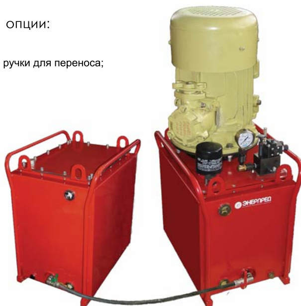
На фото: модель ВНЭР-10,0И63Т1, соединенная с дополнительным баком БД63
