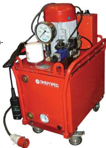
На фото: модель НЭА-1,6И63Т1-К оснащенная колесами
