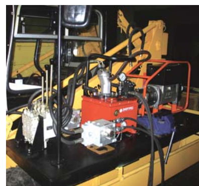
На фото: модель НГР-1,6ДД10-1 подключенная в гидросистему вспомогательной путевой машины
